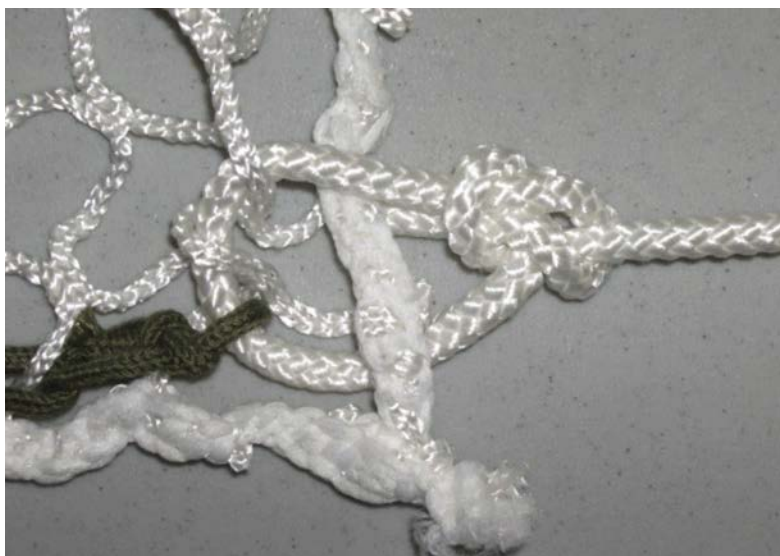
Figure 17 Fixation des bouts de corde à travers la maille – Étape 3
