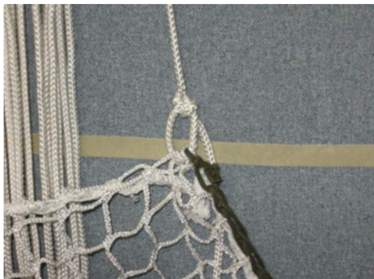
Figure 16 Fixation des bouts de corde extérieurs à travers les mailles -- Étapes 2 et 3
