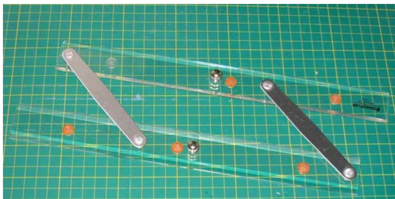
Figure 1 RÈGLE PARALLÈLE (articulée)
