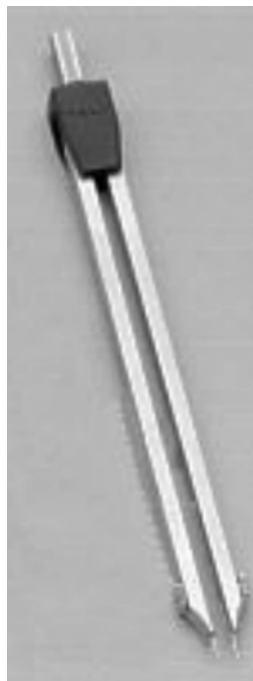
Figure 3 Compas à pointes sèches
