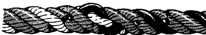
Figure 7 Épissure longue terminée
